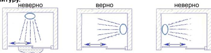
Душевая перегородка ни при каких условиях не может являться полностью герметичной конструкцией. При качественном монтаже и соблюдении правил эксплуатации она обеспечивает защиту от брызг и протеканий не менее 75% общего объёма воды.
