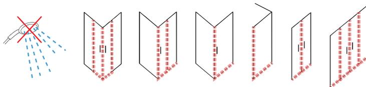
Душевая перегородка - ни при каких условиях не может являться полностью герметичной конструкцией. При качественном монтаже и соблюдении правил эксплуатации должна обеспечить защиту от брызг и подтеканий не менее 75% от общего объема используемой воды.
